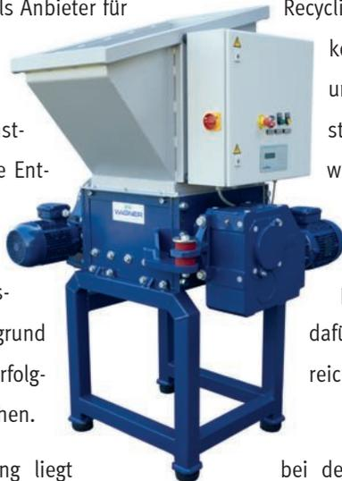
Die größte Herausforderung liegt bei den getrennt zu steuernden Wellen. Dabei sollen zwei Antriebsmotoren – anders als bei den bisherigen Lösungen – unabhängig voneinander die beiden Zerkleinerungswellen antreiben. Eine komplexe Steuerung, abhängig vom Material und dem benötigten Drehmoment, sowie damit verbunden eine mögliche Änderung der Drehrichtungen reduziert Staus und Stillstandzeiten des Shredders.
